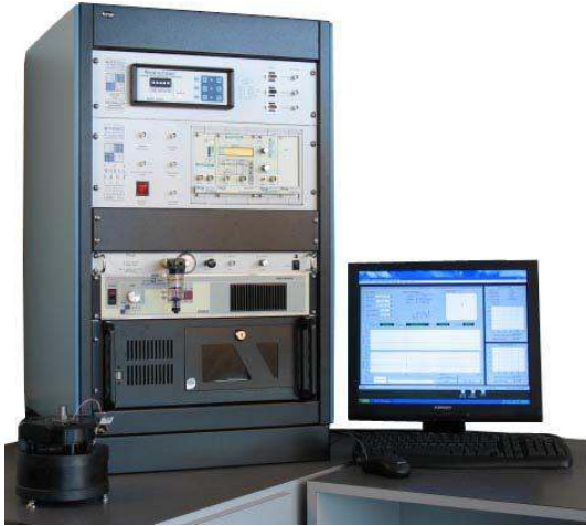
9155 系统以及集成机架 (9155D-100), 信号调节配件 (9155D-443, -445, -478) 和空气轴承激振系统 and Air-bearing Shaker System (9155D-830)
